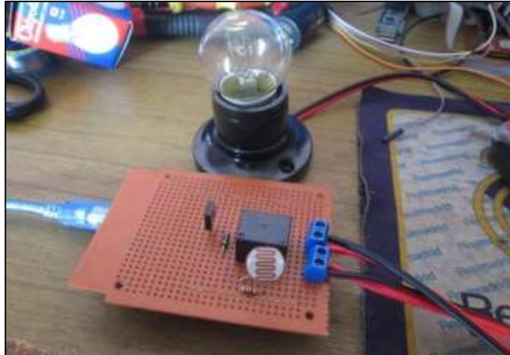
Gambar 3. Sistem Sensor Cahaya (LDR)
