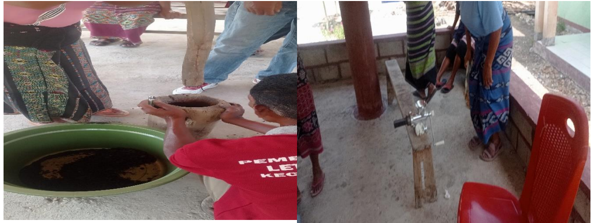
Gambar 2. Praktek Pembuatan briket arang berbahan batok lontar dan feses ternak
